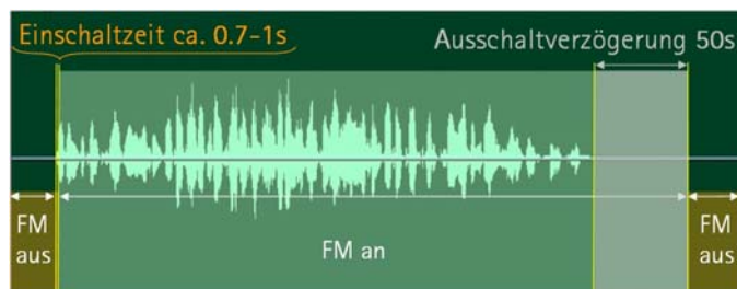
Bild 1: Schaltverhalten mit EasyFM
