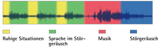
Abbildung 4: Funktionsweise der SoundNavigation. Sobald sich die akustische Umgebung verändert, detektiert dies SoundNavigation und aktiviert das passende Hörprogramm.
