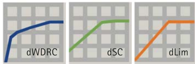
Abb. 1: Typische Eingangs-/Ausgangskennlinien von WDRC, SC und linearer Verarbeitung.
