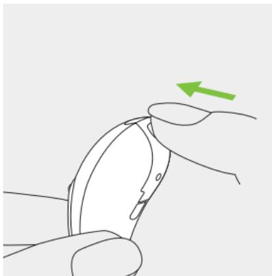
La pile est sécurisée uniquement si le tiroir pile est correctement fermé. Après avoir fermé le tiroir pile, vérifiez toujours qu'il ne peut pas être ouvert manuellement.
