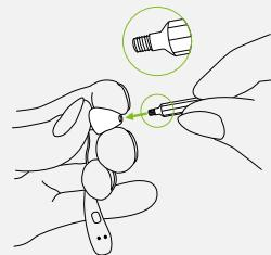
2. Drehen Sie das Wechselwerkzeug im Uhrzeigersinn, bis Sie einen leichten Widerstand spüren, und entfernen Sie dann den gebrauchten Cerumenfilter, indem Sie das Wechselwerkzeug vom Hörer abziehen.
