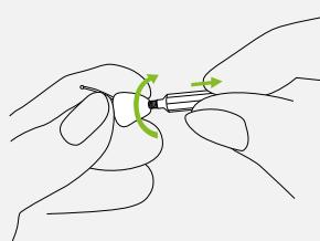
3. Entnehmen Sie den gebrauchten Cerumenfilter, indem Sie das Wechselwerkzeug entlang des Schlitzes in der Mitte des Spenders schieben und das Wechselwerkzeug abheben.
