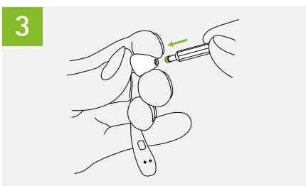
2. Nehmen Sie den neuen Cerumenfilter auf, indem Sie das geschlitzte Ende des Wechselwerkzeugs einführen.
