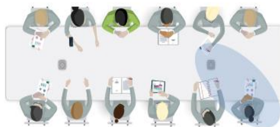
Figure 5b : Diagramme illustrant une grande réunion, avec un Roger Table Mic II placé à chaque extrémité de la table de conférence. La technologie MultiBeam sélectionne et active le faisceau présentant le meilleur RS/B, illustré en bleu. L'auditeur est représenté en vert.
