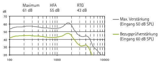
Frequenzbereich <100 Hz - 5500 Hz
