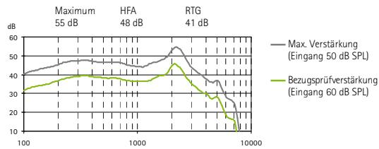
Frequenzbereich <100 Hz - 6000 Hz
