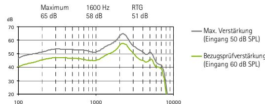
Frequenzbereich <100 Hz - 7200 Hz
