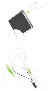
1. Schalten Sie den iCube ein und überprüfen Sie die Bluetooth Verbindung mit dem Computer.
