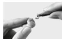
1. Öffnen Sie das Batteriefach und heben Sie die Abdeckung aus dem Scharnier. Verwenden Sie dazu das Batteriefachwerkzeug (Drehbewegung).
