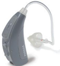
Trennen Sie den Schallschlauch von Ihrem Hörgerät, bevor Sie diesen reinigen. Beachten Sie hierbei die Bedienungsanleitung Ihres Hörgerätes. Das Schirmchen (Dome) kann auf dem Schallschlauch aufgesteckt bleiben.
