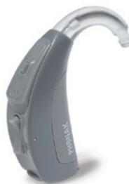
Das herausgenommene Ohrpassstück und das Hörgerät sollten täglich mit einem feuchten Reinigungstuch gereinigt werden. Überprüfen Sie dabei die Öffnung des Ohrpassstückes. Sie darf auf keinen Fall verstopft sein, da sonst die Schallübertragung zwischen Hörgerät und Ohr gestört ist. Mindestens einmal pro Woche sollte das Ohrpassstück gründlicher gereinigt werden. Bei Ihrem Hörgeräte-Akustiker sind für diesen Zweck komplette Hygienesets erhältlich.
