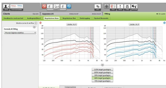
Accedere a **[Regolazione Base]** se sono necessarie regolazioni per **[Livello Guadagno]**, **[Compensazione Occlusione]**, **[BassBoost]** o **[Settaggio Compressione]**. È possibile selezionare gli strumenti dalle schede situate nella parte inferiore della schermata.
