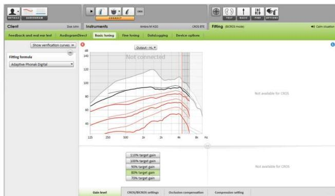
In **[Regolazione Base]** le regolazioni di **[Livello Guadagno]** dell'apparecchio acustico in un fitting BiCROS ottimizzeranno la corretta amplificazione dell'apparecchio acustico quando in modalità streaming. Le modifiche vengono applicate unicamente all'apparecchio acustico.
