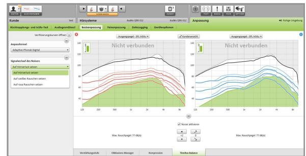
Als Grundlage für den Signalverlauf des Rauschpegels über den Noiser, kann im linken Bereich zusätzlich folgende Auswahl getroffen werden: [Auf Hörverlust setzen], [Auf weißes Rauschen setzen] oder [Auf rosa Rauschen setzen].
