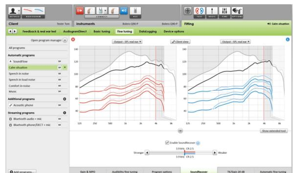
L'outil d'appareillage SoundRecover peut être développé afin d'ajuster indépendamment la fréquence de coupure et le taux de compression. Cliquez sur [Voir outil étendu] pour y accéder.
