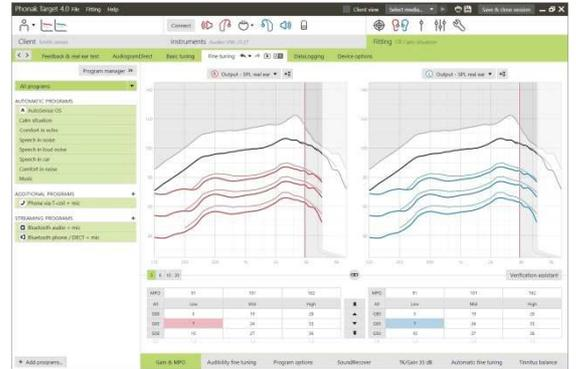
画面下部のタブから、フィッティングツールにアクセスできます。各ツールでは、特定の補正を行って補聴器を微調整することができます
