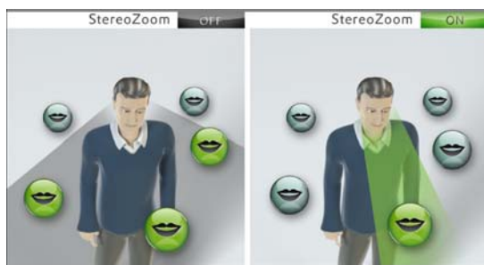
Fig 6: Le faisceau des microphones directionnels monauraux est large vers l'avant (faisceau gris). StereoZoom crée un faisceau très focalisé à l'avant (vert) permettant de se concentrer sur une seule voix dans une foule.
