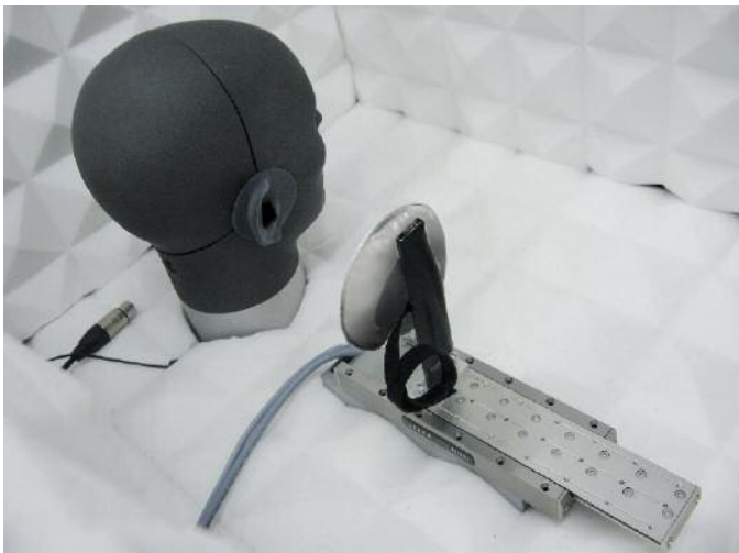
Figure 3: Installation d'essai pour évaluer les performances des systèmes anti-larsen dans des conditions réalistes.
