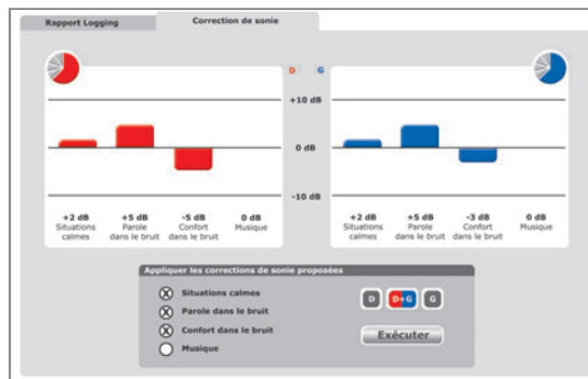
Figure 4 Correction de sonie : suggestions d'adaptation fine du gain dans chaque programme de base d'après l'analyse des réglages de volume faits par le patient.
