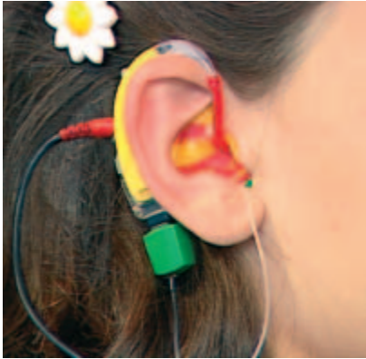
Figure 5 Installation de mesure de la RECDirect
