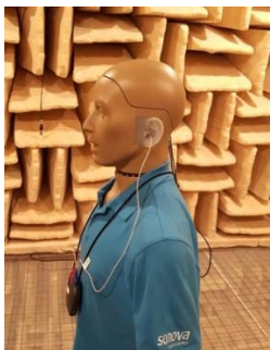
Figure 3. Configuration du KEMAR dans une chambre anéchoïque pour la mesure du diagramme polaire
