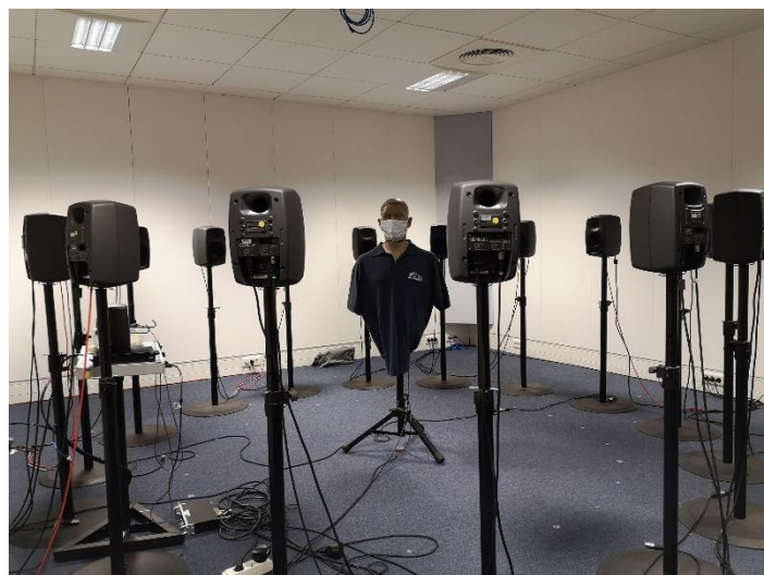
Figure 3. Configuration pour les enregistrements vocaux dans le laboratoire qui devaient être utilisés dans les tests à distance.
