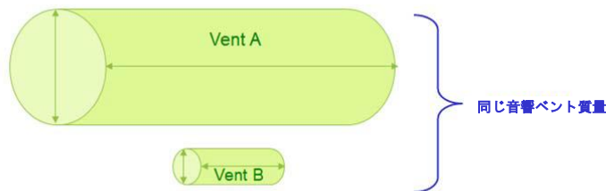
図 4： 音響ベント質量の実例
