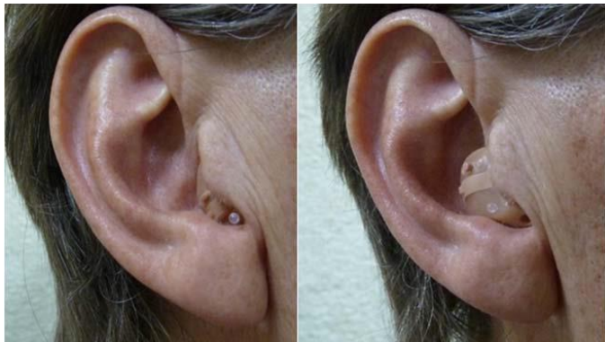
図 1：最大機能を搭載した一番小さいオーダーメイド補聴器、パート V (左) とパート Q (右)
