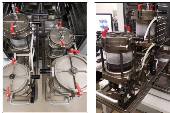
図 1：温度管理されたテストチャンバーで実施された海水とプール水を使ったテストのセットアップ。
