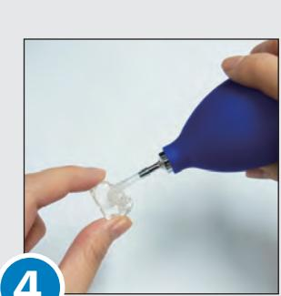
4 イヤモールドは水洗いし、水気を拭き取ります。チューブの中の水は、エアパッファーを使って吹き飛ばしてください。
