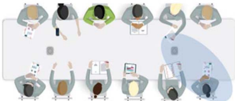
Рис. 6: Схема, иллюстрирующая большое совещание с двумя передатчиками Table Mic II, размещенными по концам стола. Технология MultiBeam выбирает и активирует единственный луч направленности с максимальным ОСШ (показан синим цветом). Слушатель отмечен зеленым цветом.
