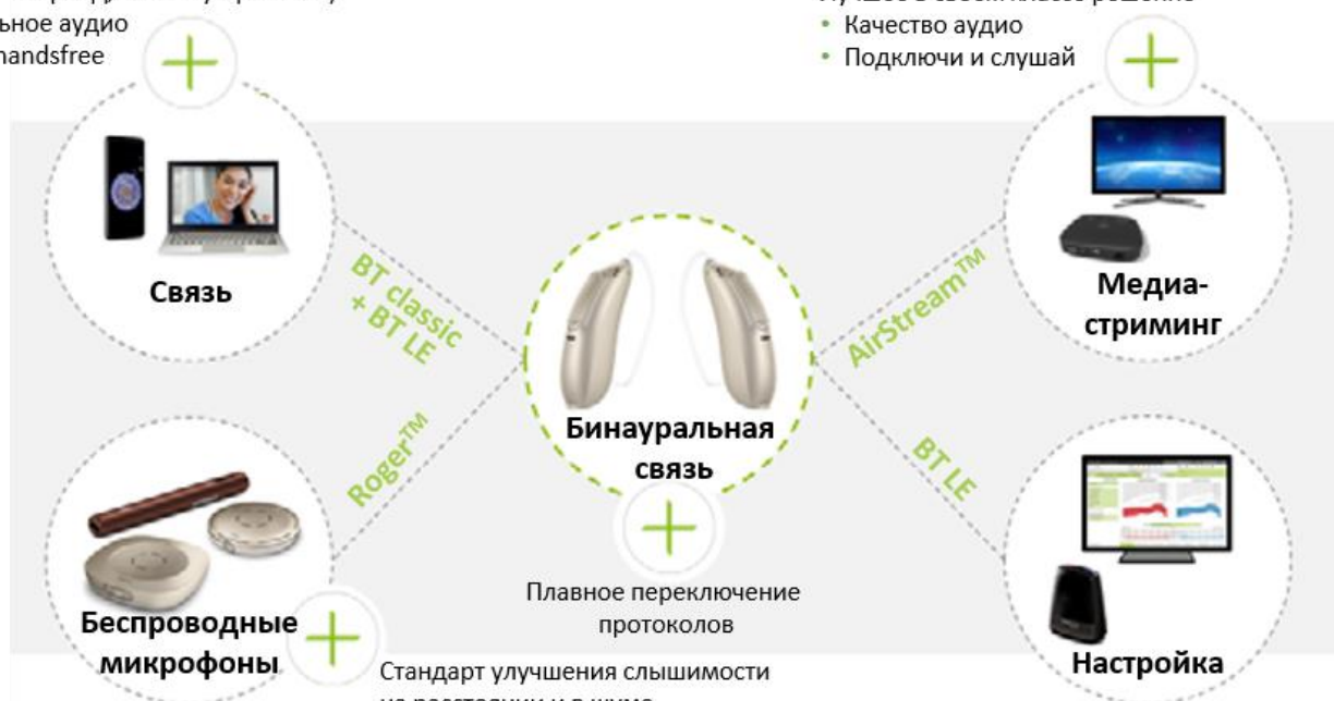
Рис. 2: Различные протоколы, интегрированные в микрочип SWORD.
